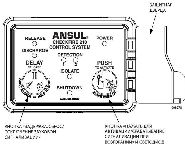
КНОПКА «ЗАДЕРЖКА/СБРОС/ ОТКЛЮЧЕНИЕ ЗВУКОВОЙ СИГНАЛИЗАЦИИ»
